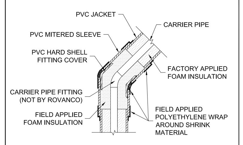
MITERED 45° FITTING COVER DETAIL
