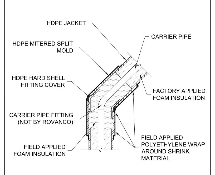
MITERED 45° FITTING COVER DETAIL
