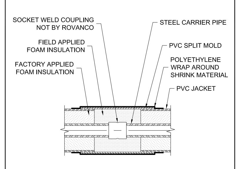
SMALL DIA. CARRIER - FIELD JOINT DETAIL
