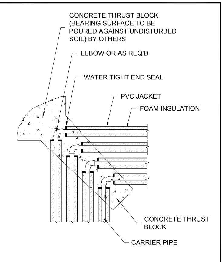
FRP THRUST BLOCK DETAIL N.T.S.
