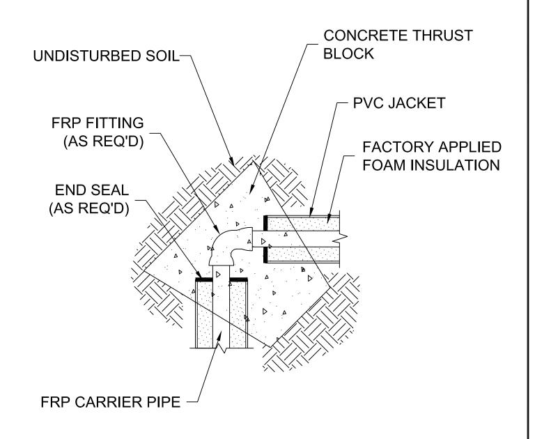
FRP THRUST BLOCK DETAIL N.T.S.
