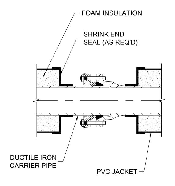
DUCTILE IRON MECHANICAL JOINT DETAIL N.T.S.
