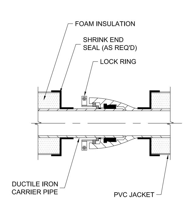
DUCTILE LOCK RING JOINT DETAIL N.T.S.
