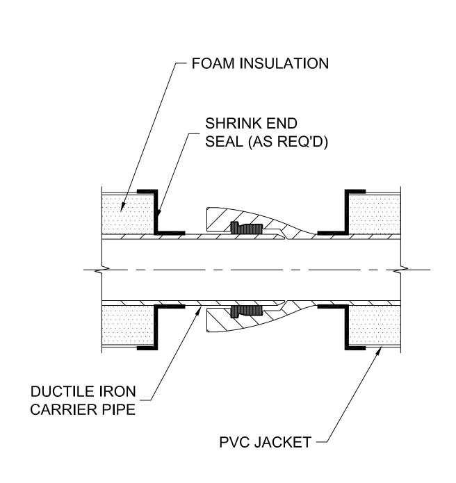
DUCTILE IRON PUSH ON JOINT N.T.S.
