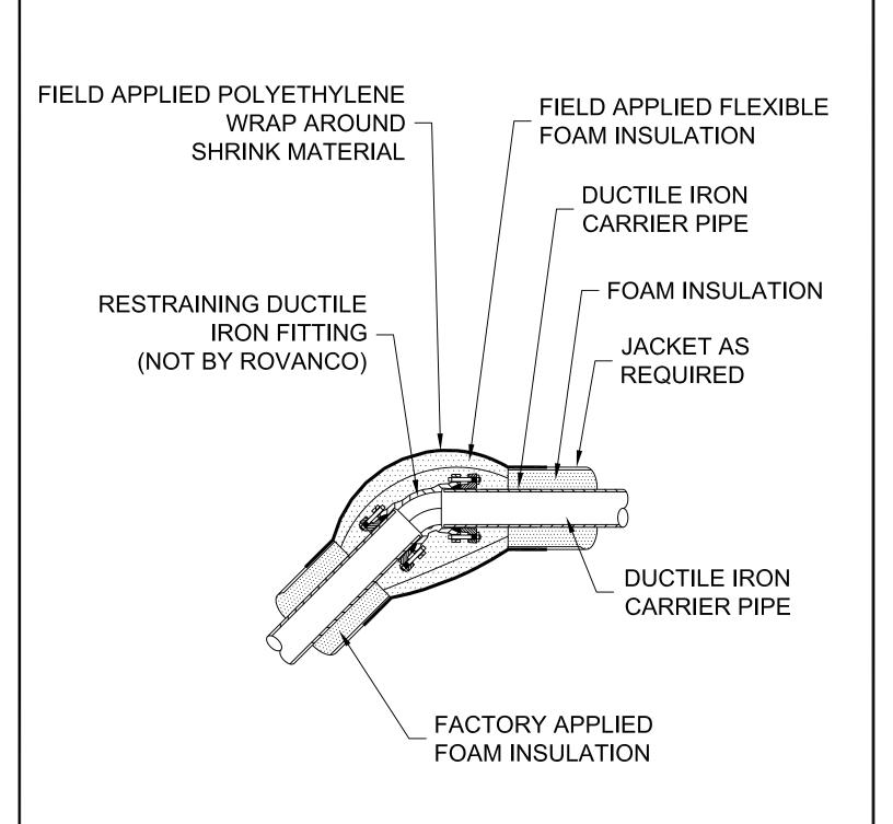
45° DUCTILE IRON ELBOW DETAIL
