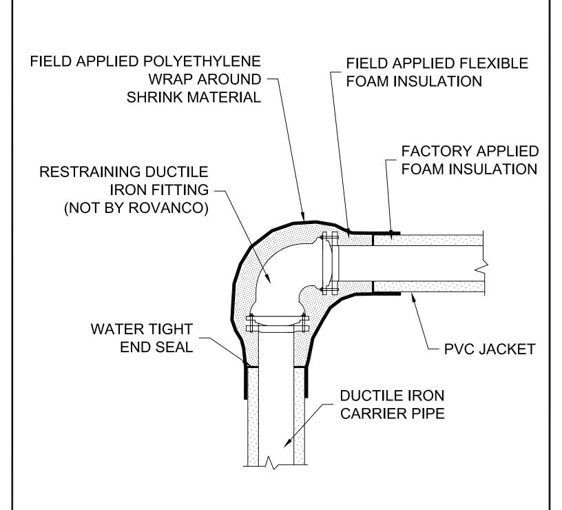
DUCTILE IRON FITTING DETAIL
