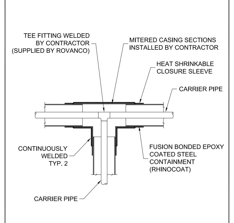
QUICK FIT CONTAINMENT TEE DETAIL N.T.S.
