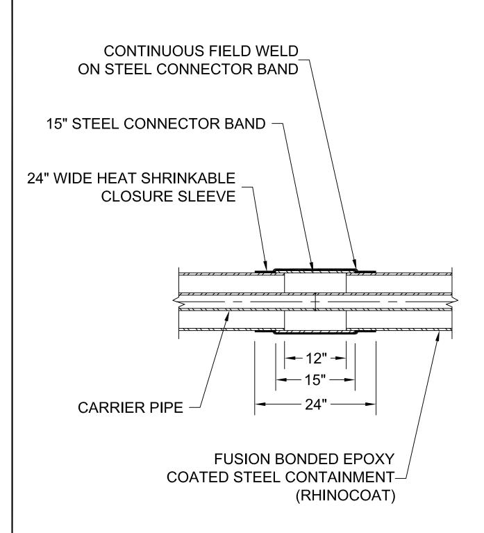
STEEL CONTAINMENT FIELD JOINT DETAIL
