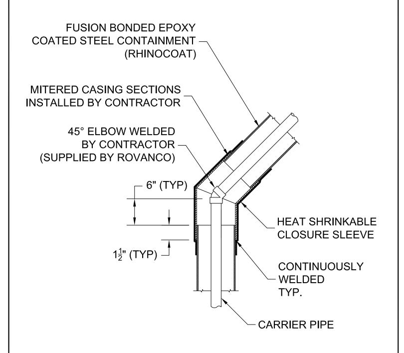
QUICK FIT CONTAINMENT 45° ELBOW DETAIL
