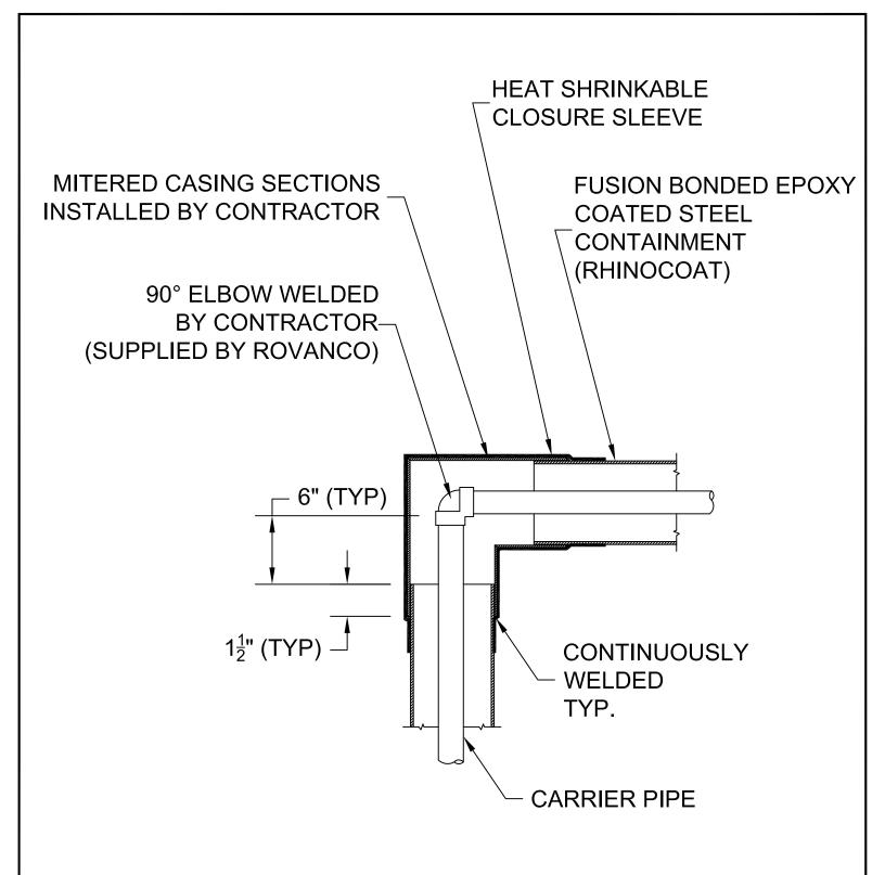
QUICK FIT MITERED CONTAINMENT ELBOW DETAIL N.T.S.
