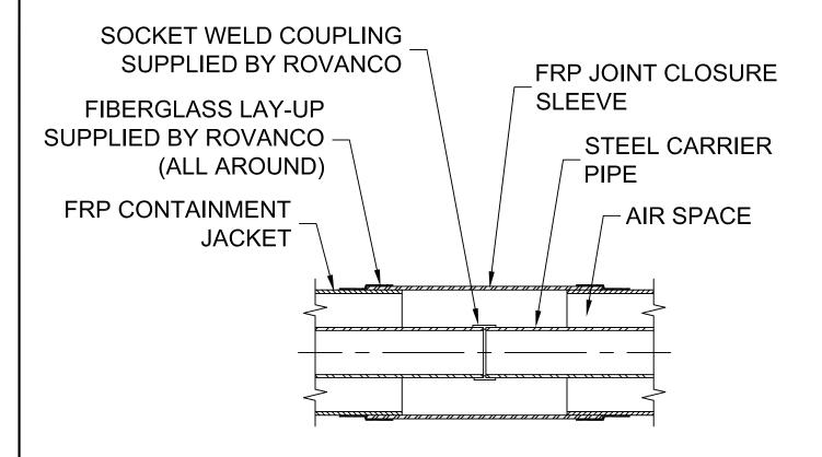
FRP CONTAINMENT FIELD JOINT DETAIL N.T.S.
