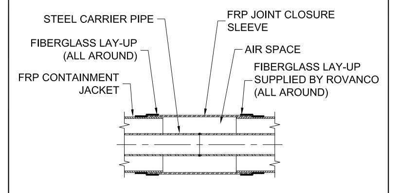
FRP JACKET FIELD JOINT DETAIL N.T.S.
